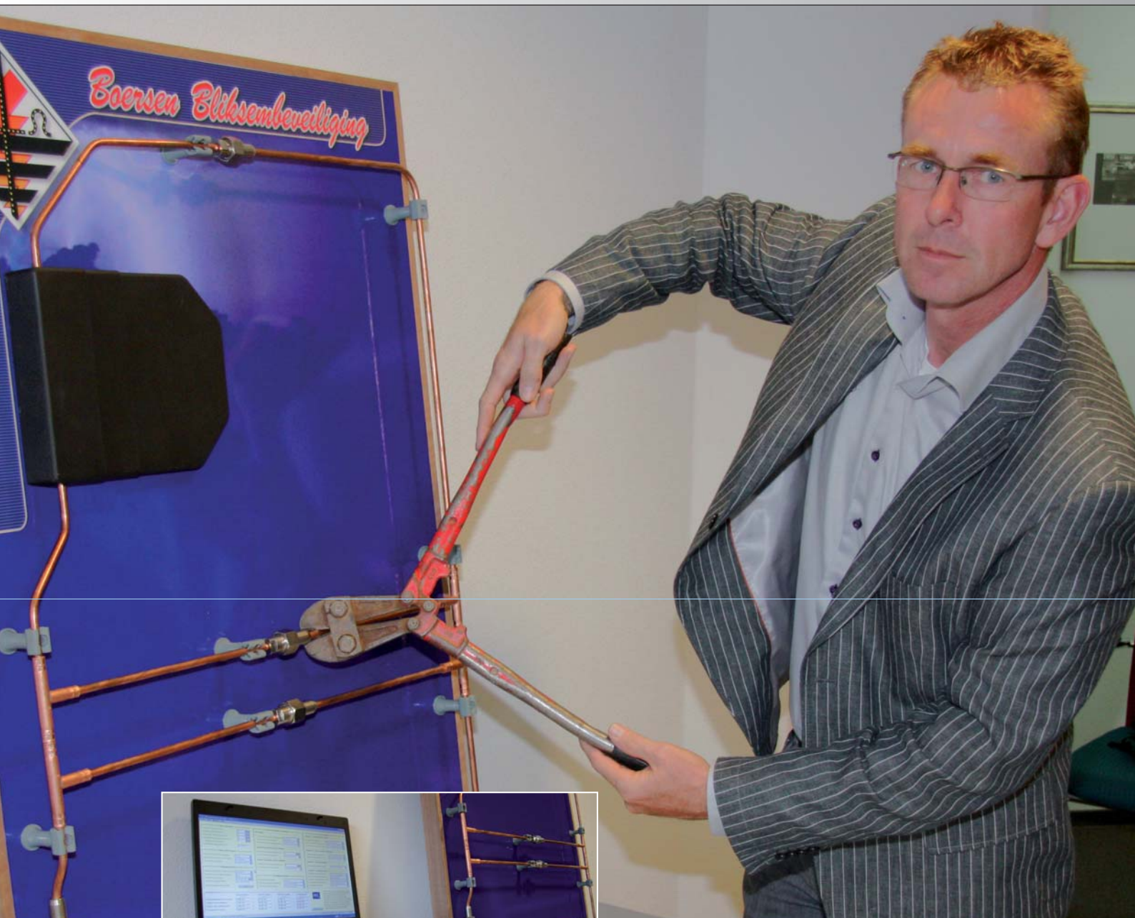
Hans Boersen zet de betonschaar in de bliksembeveiliging, de processor signaleert dat en stuurt alarmsignalen uit naar verschillende ontvangers.
